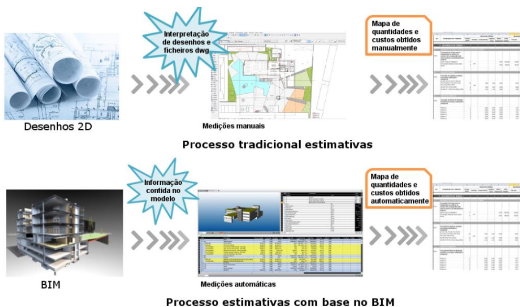
Figura 3.14 – Capacidade do BIM em obter mapas de quantidades automáticos em oposição ao método tradicional de medições.
