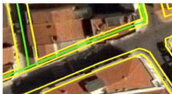
Figura 3.15 - Representação da solução aplicada para a derivação da linha central.
