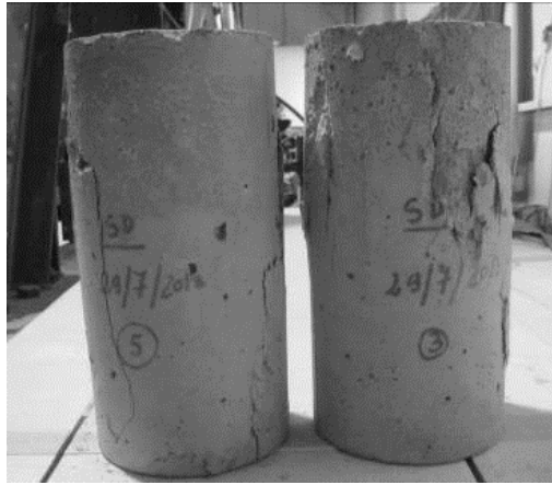
Figura 3.8 - Modo de rotura dos provetes de betão.
