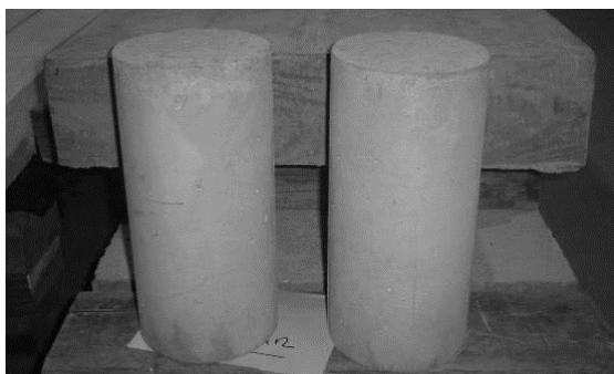
Figura 3.6 - Provetes cilíndricos antes da realização do ensaio de compressão uniaxial.
