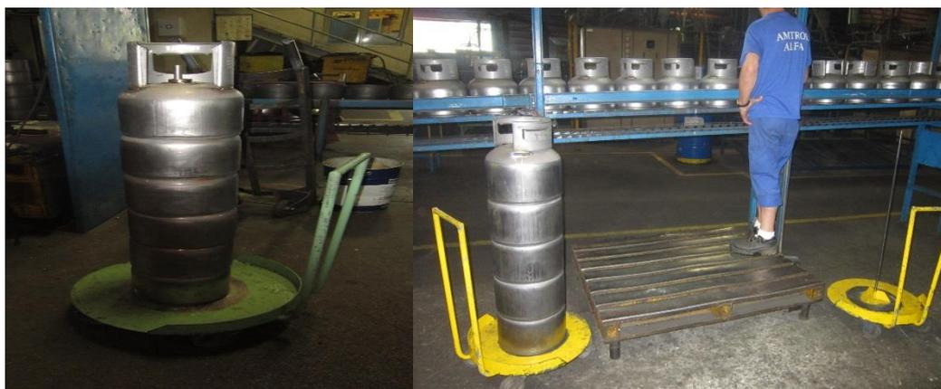
**Figura 71 - Manuseamento das coquilhas no posto de inspeção**
