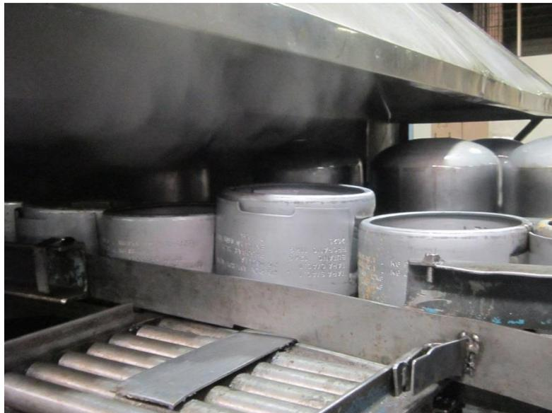
**Figura 36 - Entrada no tanque de desengorduramento das coquilhas e dos acessórios**
