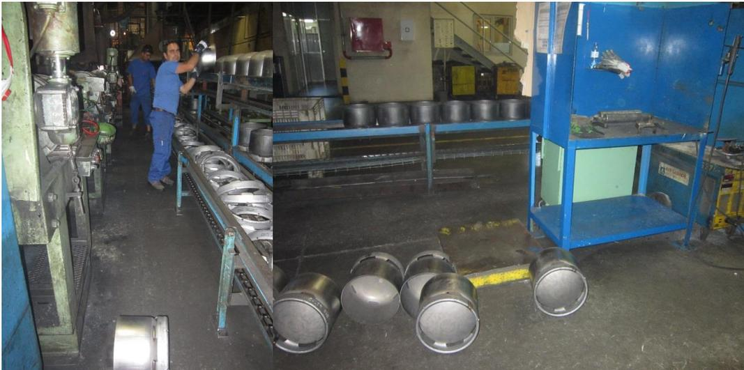
**Figura 52 - Transporte e colocação de coquilhas com pés junto do posto de reparação**
