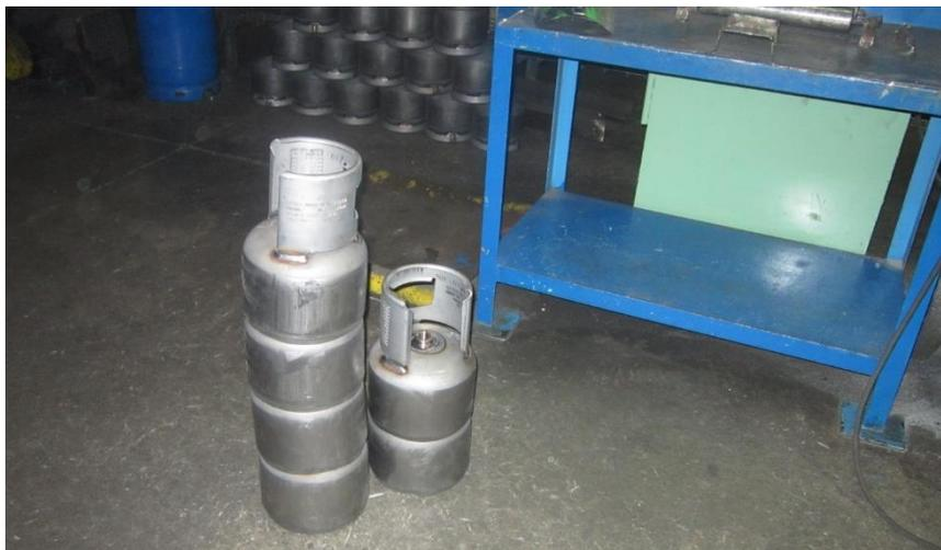
**Figura 53 - Colocação coquilhas com bolacha e gola junto do posto de reparação**
