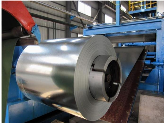
**Figura 28 - Bobina de aço aplicada numa prensa de corte de chapa Fonte:(Technology, 2009)**
