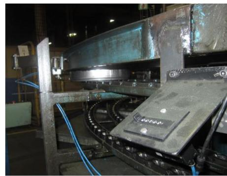
Figura 61 – Contador pneumático
