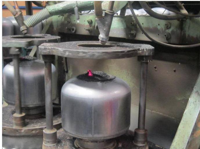
**Figura 39 - Soldadura da bolacha à coquilha**
