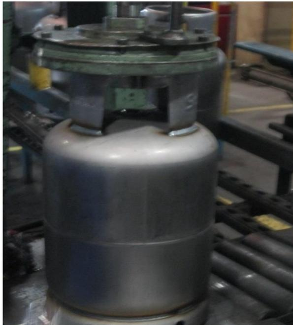
**Figura 41 - A garrafa de gás resultante do encaixe das duas coquilhas compostas - superior e inferior.**
