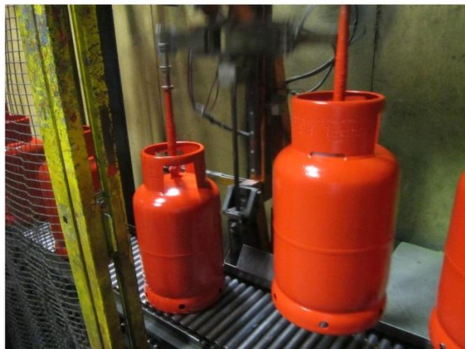
**Figura 45 - Colocação das garrafas pintadas no transportador de correntes.**
