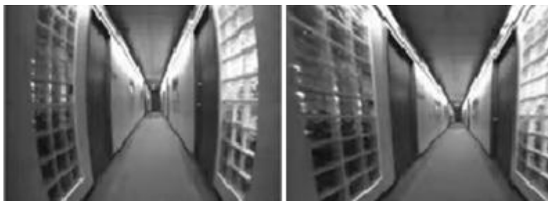
Figura 13 - Imagem distorcida (esquerda) e imagem calibrada (direita) [2]
