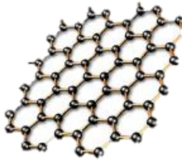
**Fig.49-** Representação esquemática do grafeno.
