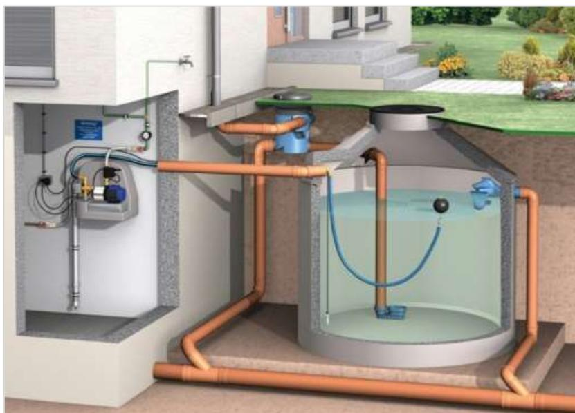
Figura 16 - Reservatório de água da chuva numa instalação de SAAP
