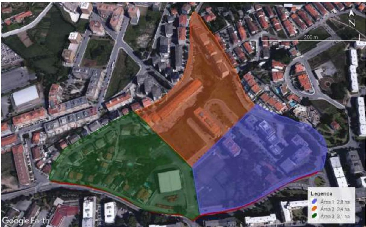
Figura 35 - Delimitação das áreas de contribuição de cada trincheira de infiltração
