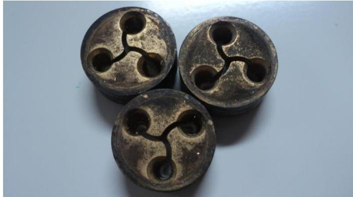
*Figura 37: Insertos de espirais com 3 hélices obsoletos.*
