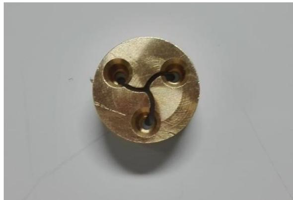
*Figura 38: Inserto de espirais com 3 hélices novos.*
