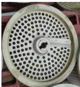
*Figura 34: Posicionamento dos insertos e rotação da faca.*
