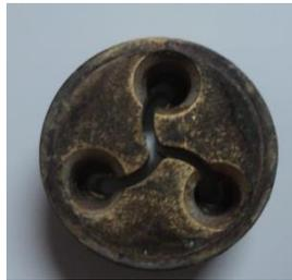
Figura 40: Inserto de Espirais de 3 hélices desgastado.
