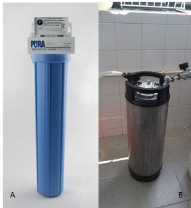
Figura 11: A- Aparelho de ultravioleta (Retirado de Pure Water Products). B- Recipiente de receção do mosto antes de ir para o aparelho de UV.
