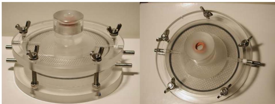
Figura 7 – Fotografias do módulo utilizado na medição da permeabilidade gasosa dos filmes estudados.
