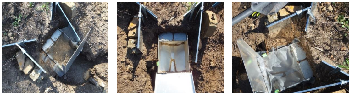
Fotografia 17 - Sequência dos procedimentos na caixa de erosão, com recolha dos sedimentos erodidos e manutenção da caixa
