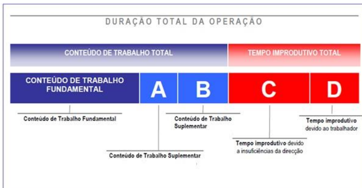
Figura 6 - Decomposição da duração total de fabricação de um produto
