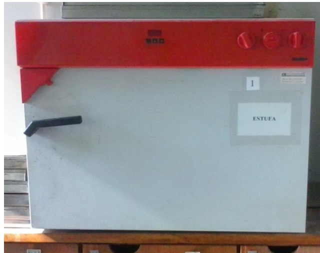
Figura 4. Estufa Binder FD 115 # 04 – 73401 utilizada na secagem dos laminados de juta que sofreram tratamento alcalino.
