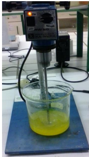
Figura 6. Agitador mecânico utilizado na homogeneização da mistura do absorvedor de UV - Tinuvin P - com o agente de cura – SZ 8525.
