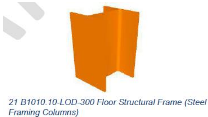
Figura 12 – Exemplo pilar metálico LOD 300 (BIMFORUM, 2016)
