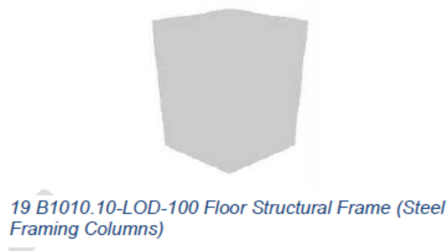
Figura 10 – Exemplo pilar metálico LOD 100 (BIMFORUM, 2016)
