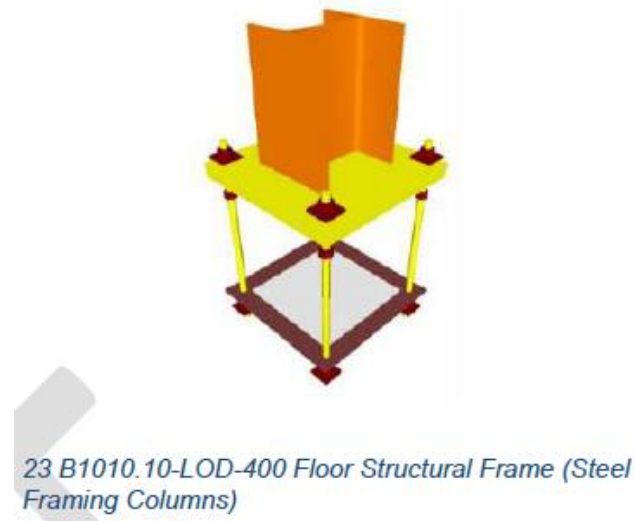
Figura 14 – Exemplo pilar metálico LOD 400 (BIMFORUM, 2016)
