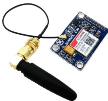
Figura 3.52 - Modem 3G SIM800 da SIMCOM
