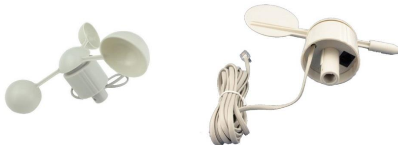
Figura 3.47 - Peças adquiridas para medição da intensidade e direção do vento
