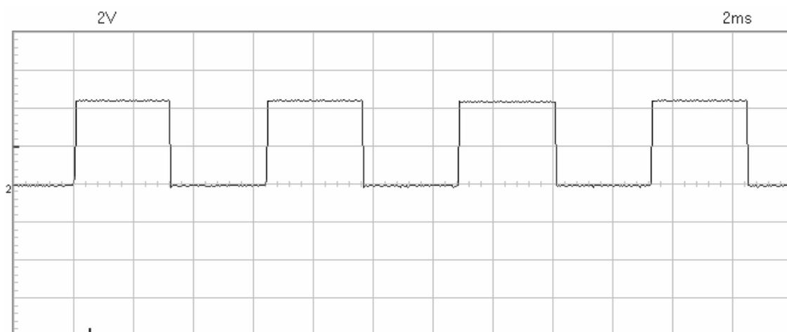
**Figura VI-3:** Forma de onda do sinal de saída do *encoder* no movimento descendente.
