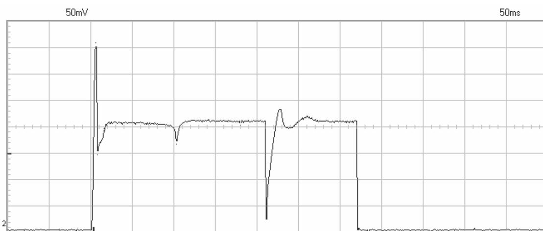
**Figura VI-8:** Forma de onda, de consumo de corrente com uma resistência em série de 0.05Ω, com as válvulas interior a abrir e exterior a fechar.
