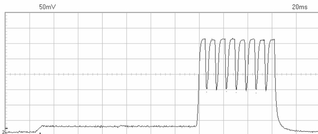
**Figura VI-11:** Forma de onda, de consumo de corrente com uma resistência em série de  $10\Omega$ , com o *EnOcean* na versão antiga a “acordar”, a processar e a voltar a “dormir”, num dos seus ciclos de 2 em 2 segundos.
