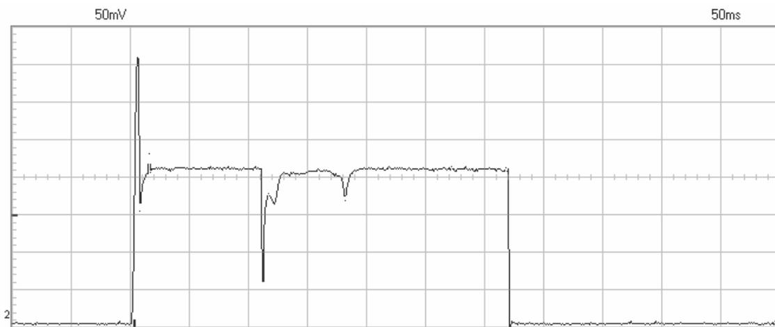
**Figura VI-9:** Forma de onda, de consumo de corrente com uma resistência em série de  $0.05\Omega$ , com as válvulas interior a fechar e exterior a abrir.
