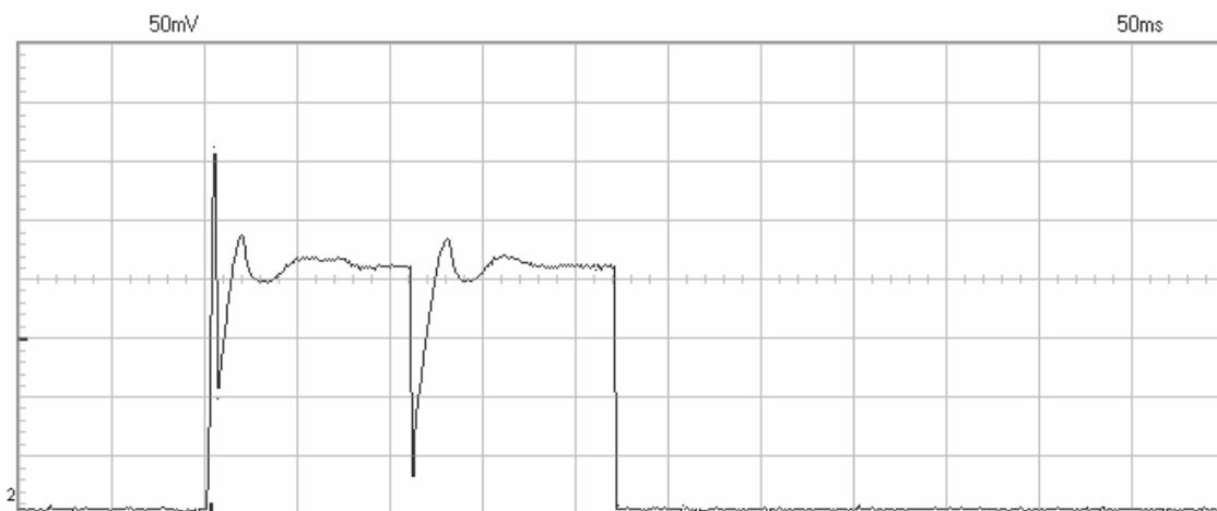
**Figura VI-7:** Forma de onda, de consumo de corrente com uma resistência em série de  $0.05\Omega$ , com as válvulas interior e exterior a fecharem.
