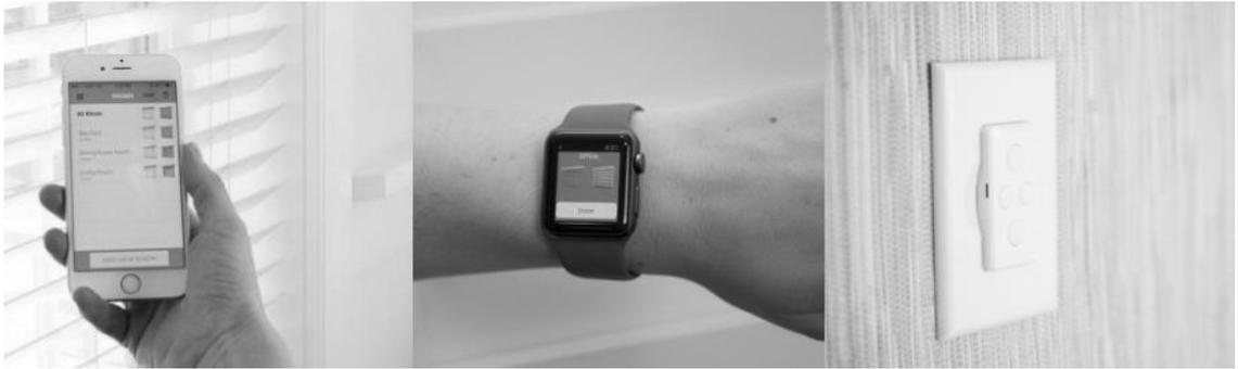
**Figura II-4:** Controlo remoto de uma *MySmartBlinds* através de uma aplicação para *tablets*, *smartphones* ou *smartwatches* ou através de um controlo remoto sem fios que pode ser aplicado na parede.
