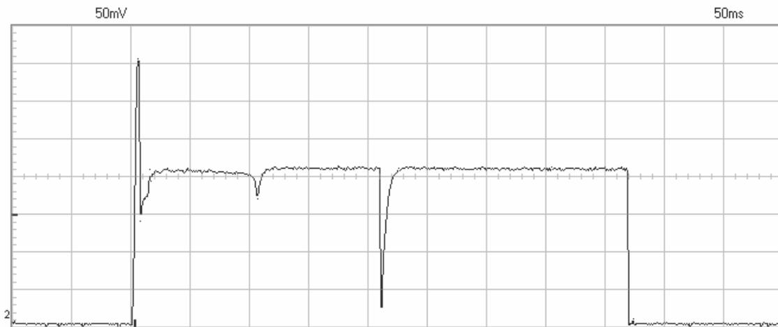
**Figura VI-6:** Forma de onda, de consumo de corrente com uma resistência em série de  $0.05\Omega$ , com as válvulas interior e exterior a abrirem.
