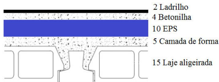
Figura 18 - Solução de melhoria – Pavimento R/C (dimensões em cm)
