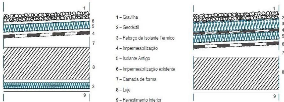
Figura 33 - Reforço do isolamento térmico inferior (esquerda). Reforço do isolamento térmico superior (direita). (Fonte: [42])
