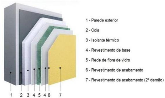
Figura 27 - Sistema de isolamento térmico com revestimento delgado
