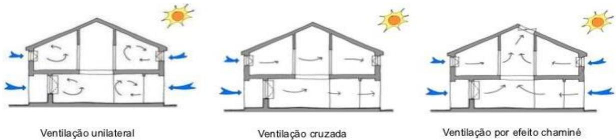
Figura 18 - Formas de ventilação: ventilação unilateral; Ventilação cruzada; Ventilação por efeito chaminé [31]
