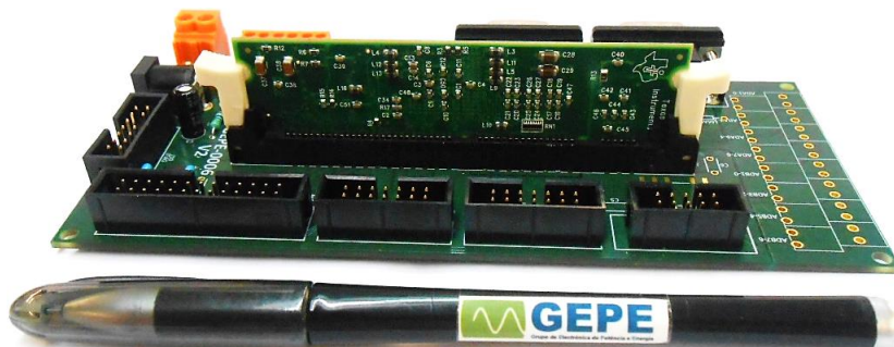
Figura 5.22 - Placa do DSC e de suporte do DSC (desenvolvida pelo GEPE).
