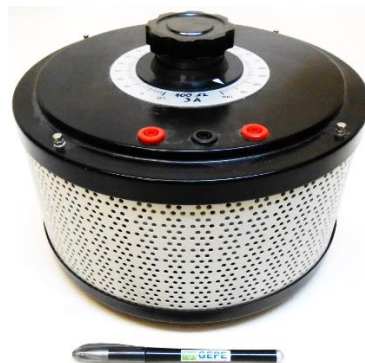
Figura 5.2 – Reóstato utilizado no sistema de emulação do painel solar fotovoltaico.
