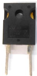
Figura 5.5 – Díodo rápido STTH3012 utilizado no conversor step-up .
