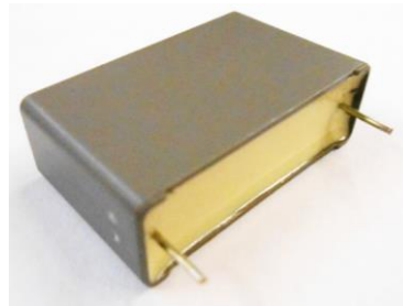
Figura 5.6 – Condensador MKT1820 utilizado na saída do conversor step-up .
