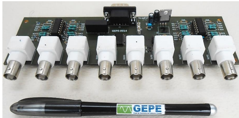
Figura 5.28 – Placa do DAC (desenvolvida pela GEPE).
