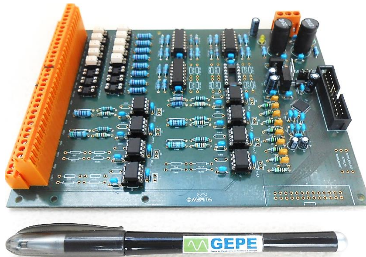
Figura 5.27 – Placa de condicionamento de sinal (desenvolvida pelo GEPE).
