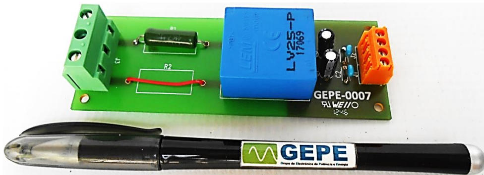
Figura 5.20 - Placa do sensor de tensão utilizada (desenvolvida pelo GEPE).
