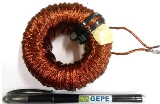
Figura 5.15 – Indutância de 3,1 mH utilizada no conversor step-up-down bidirecional.
