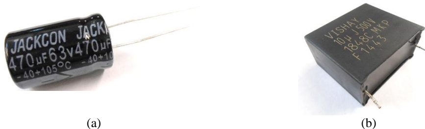
Figura 5.3 – Condensadores utilizados na entrada do conversor: (a) Condensador eletrolítico; (b) Condensador de polipropileno.
