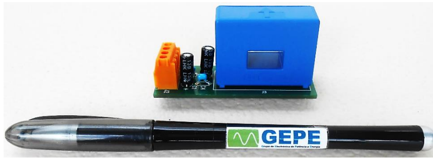
Figura 5.21 – Placa do sensor de corrente utilizado (desenvolvida pelo GEPE).
