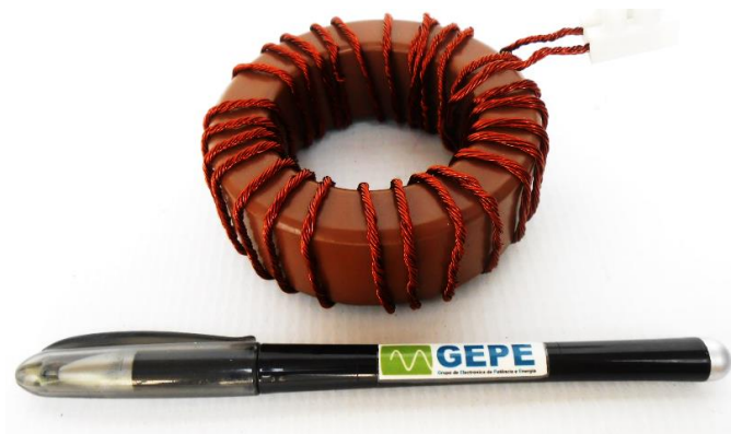
Figura 5.7 – Indutância de 94,1 \mu\text{H} utilizada no conversor step-up .
