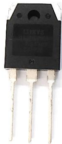
Figura 5.4 – MOSFET IXFQ50N50P3 utilizado no conversor step-up .
