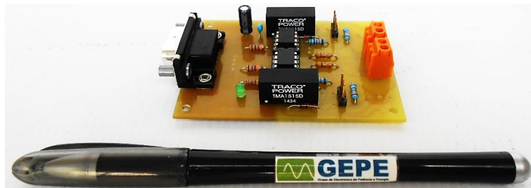
Figura 5.30 – Placa de driver dos semicondutores de potência (desenvolvida pelo GEPE).
