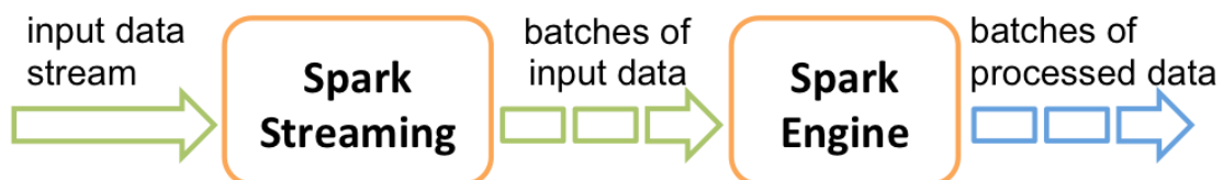
Figura 10 - Funcionamento do Spark Streaming . Retirado de (The Apache Software Foundation, 2016d)
