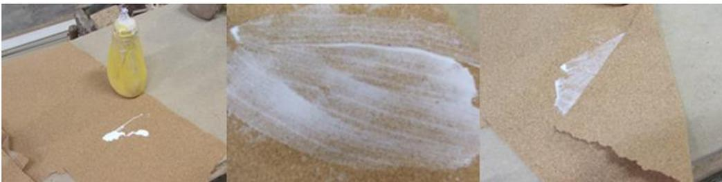
FIGURA 29 - Colagem Manual para estudo de cola e verificação de resultados.
