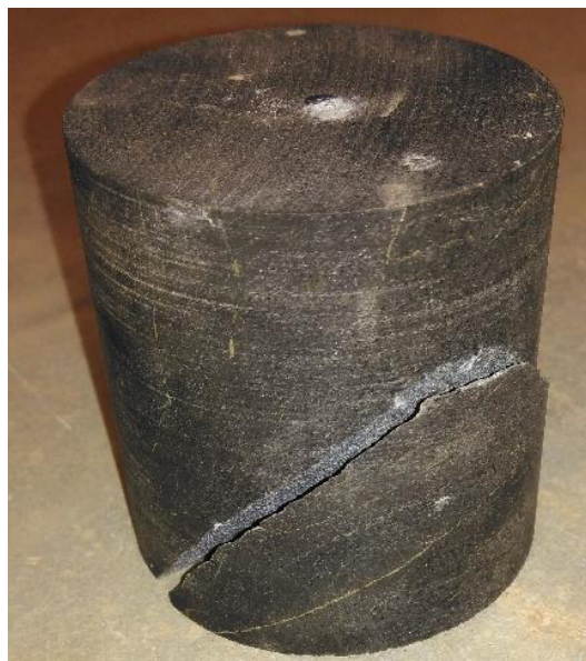
Figura 2.7 Rotura não válida para o ensaio de carga pontual axial.
