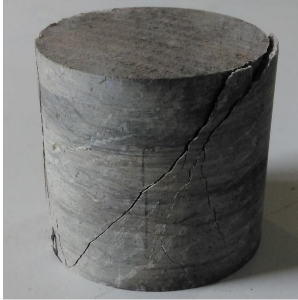
Figura 4.2 Amostra (22.1.1) com fraturas de cisalhamento desenvolvidas durante o ensaio de compressão uniaxial.
