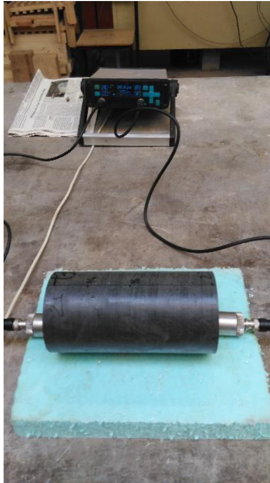
Figura 2.3 Ensaio da velocidade de propagação do som.
