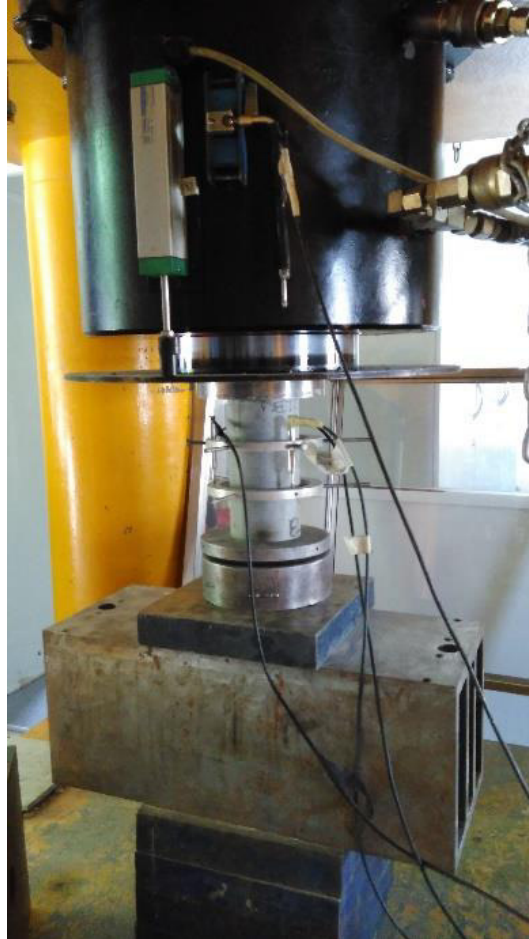
Figura 2.8 Ensaio de módulo de elasticidade estático.
