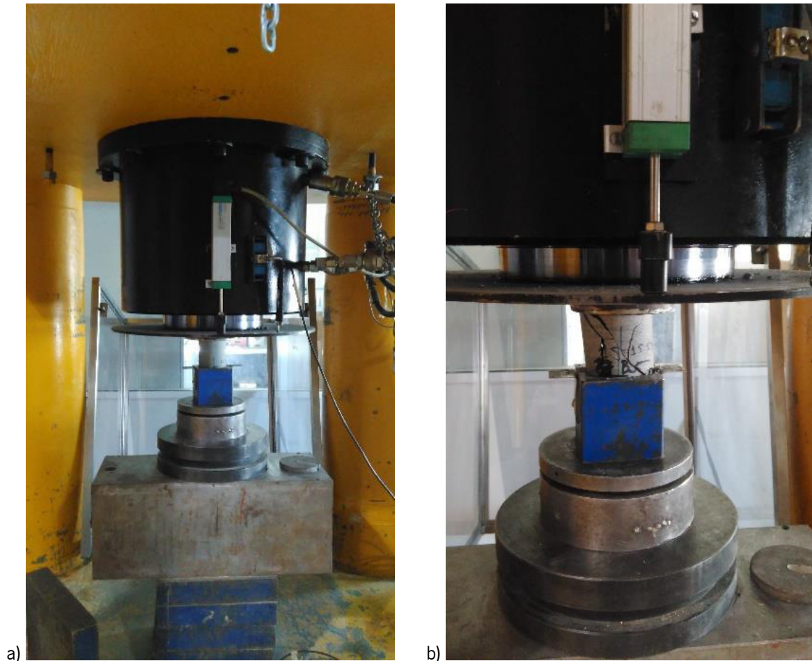
Figura 2.4 Resistência à compressão uniaxial: a) antes da rotura; b) depois da rotura.
