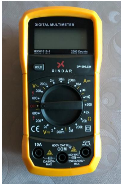
Figura 26- Multímetro Xindar DP1000.031, selecionado para a realização da experiência.
