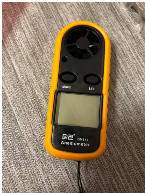
Figura 24 - Anemómetro utilizado na construção do kit eólico
