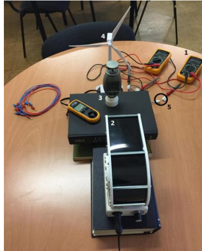
Figura 29- Imagem fotográfica do kit eólico montado (1-multímetro; 2-soprador; 3-anemómetro; 4- turbina eólica; 5- resistência)
