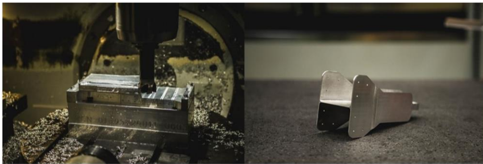
Figura 15 - Exemplo de maquinação CNC (à esquerda) e peça produzida (à direita)
