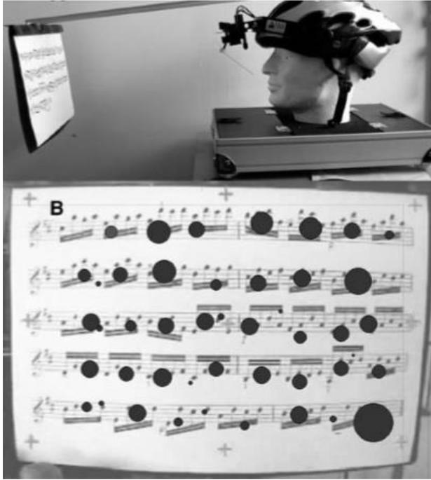
Figura 3: Um dispositivo de *eyetracking* montado na cabeça do violinista.<sup>27</sup>
