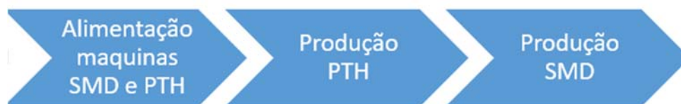
Figura 25: Processo produtivo (PTH e SMD)
