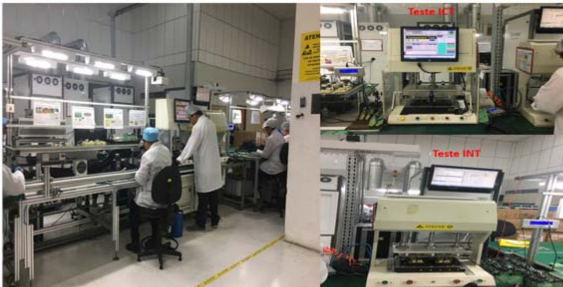
Figura 32: revisão LQC e testadores ICT e INT
