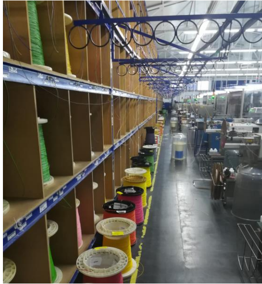
Figura 13 - Disposição das bobinas na estante junto às máquinas de corte
