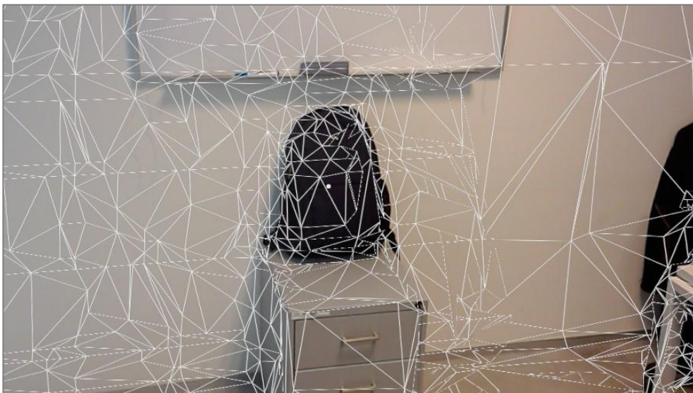
Figura 39 - Visualização das meshes associadas às superfícies que são obtidas através de técnicas de mapeamento espacial pela utilização do dispositivo Hololens.
