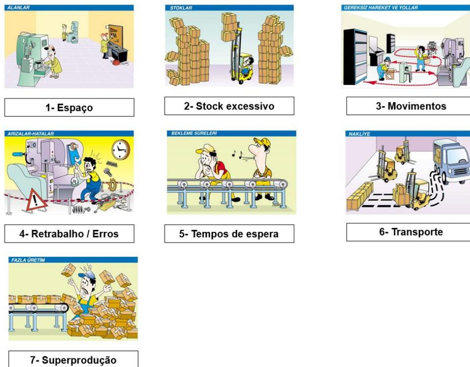
Figura 4 - Os sete tipos de desperdícios do BPS (adaptado Bosch, 2013)
