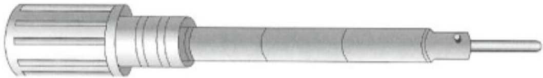
Figura 24 - Mandril para retificação "Honing" (adaptado de (12))
