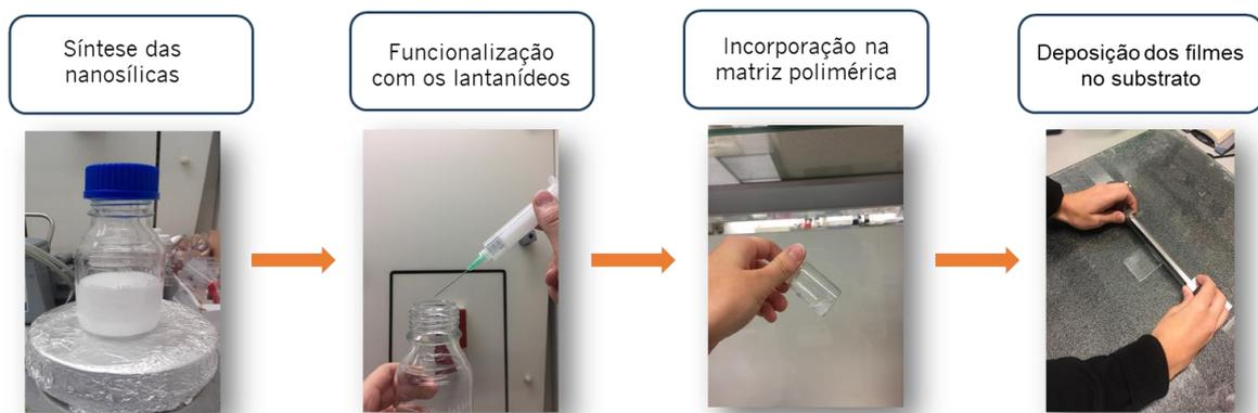
**Figura 13.** Representação esquemática do processo de produção dos protótipos.
