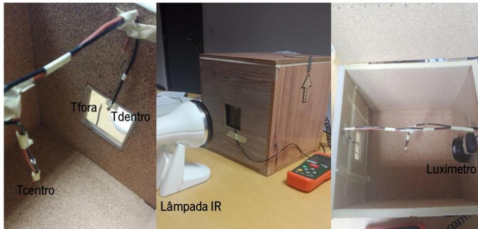
**Figura 14.** Caixa de desempenho térmico, com a localização dos termopares Tfora92, Tcentro93, Tdentro94, o luxímetro e a lâmpada de IR.
