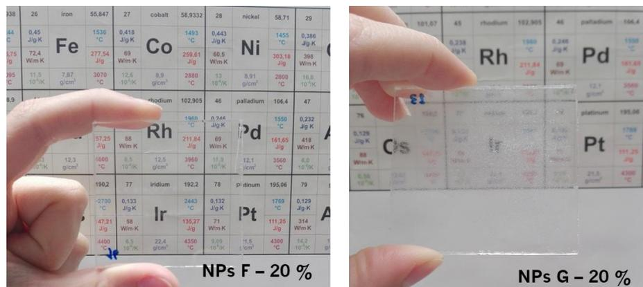
Figura 37. Imagem dos vidros revestidos com filmes poliméricos com incorporação de 20 wt % de NPs F e G.
