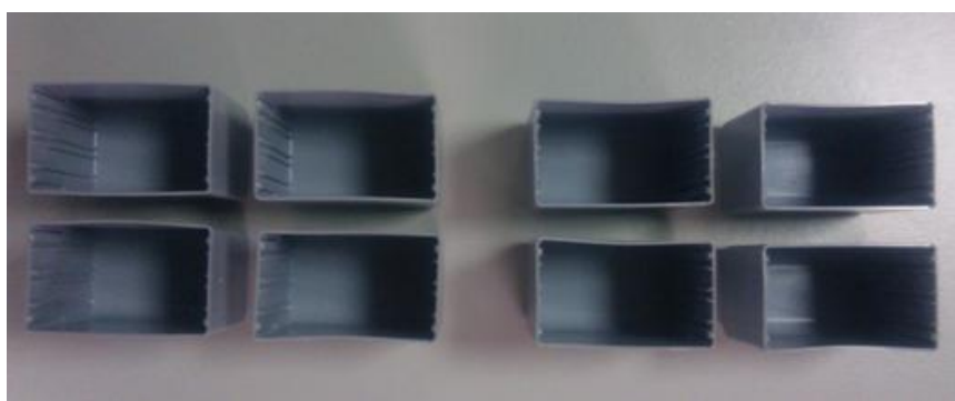
Figura 8 - Copos em PBT com defeito
