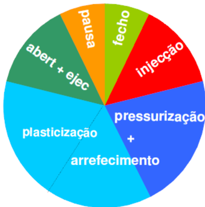
Figura 3 - Ciclo de moldação [6]
