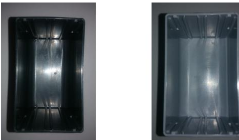
Figura 13 – (Lado esquerdo) Copo 573550 PBT 15% GF; (Lado direito) Copo 5735 PBT 30% GF CZ
