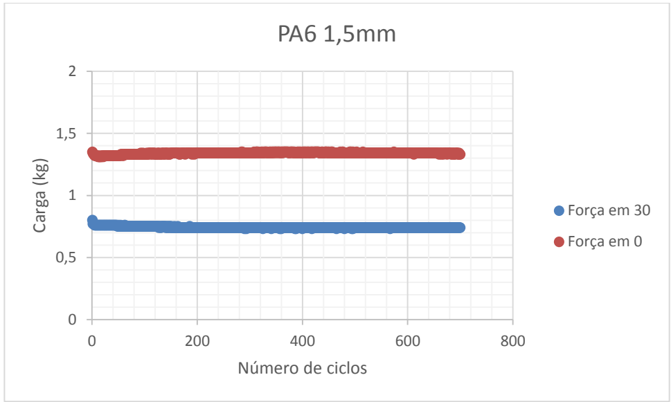
Figura 34 - Ensaio no EP do cabo PA6 com diâmetro 1,5mm
