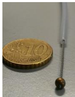
Figura 5 – Pormenor do terminal do cabo
