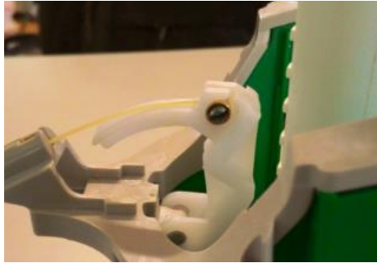
Figura 21 - Encaixe no sistema de acionamento com cerra-cabos
