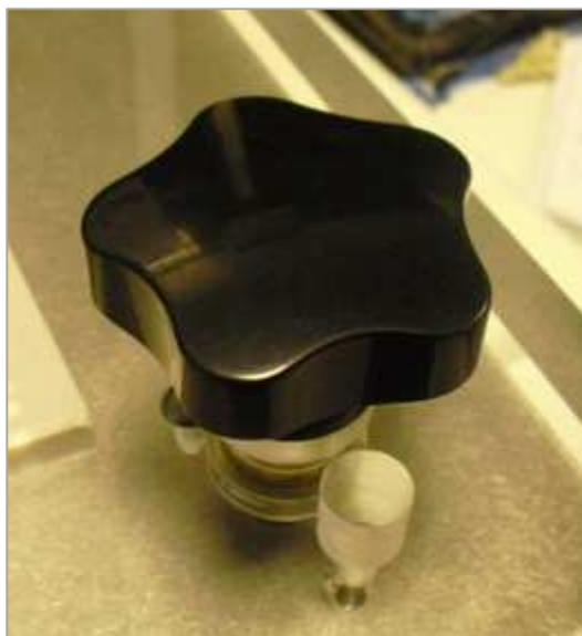
**Figura 12 - Manípulo roscado no veio sobre a placa de acrílico.**
