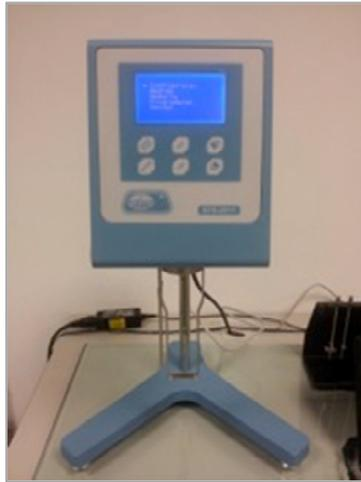
**Figura 21 - Viscosímetro Selecta, modelo STS-2011 L.**
