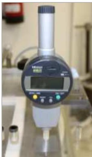
**Figura 16 - Comparador portátil Mitutoyo modelo Absoluto 543-464B.**
