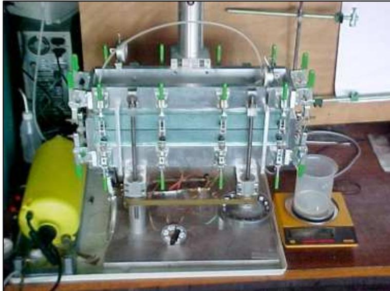
**Figura 3 - Permeabilímetro CLS [6].**
