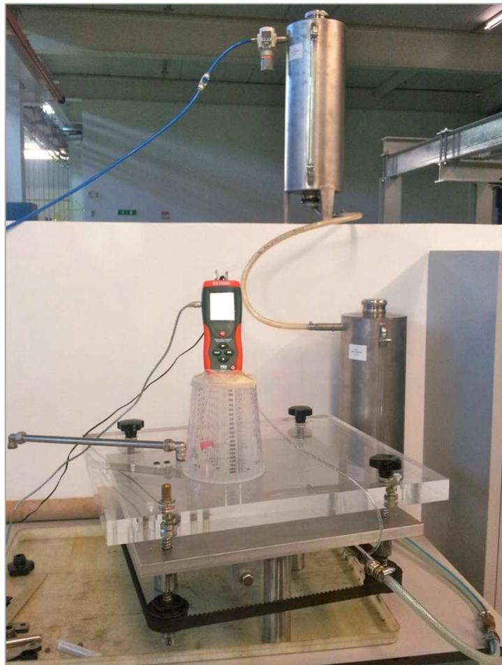
**Figura 22 – Permeabilímetro desenvolvido.**
