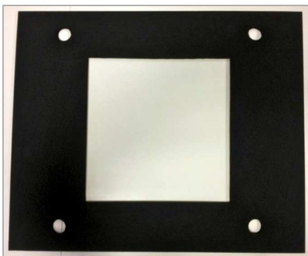
**Figura 15 - Espuma EPDM de célula fechada 500x500.**
