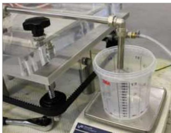
**Figura 19 - Recolha do fluído num recipiente colocado numa balança.**
