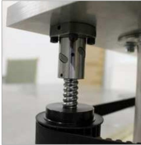
**Figura 10 - Fixação dos fusos axiais de esferas à placa de aço e incorporação do veio. Montagem da polia e da correia.**
