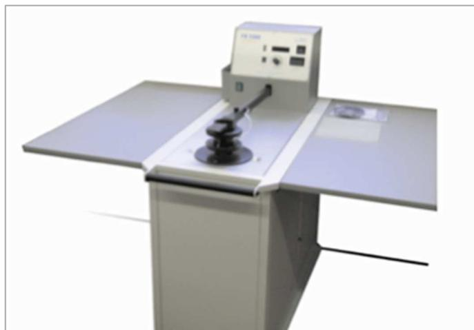
**Figura 1 - Permeabilímetro FX33000 [10].**
