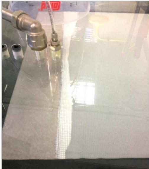
**Figura 43 - Frente de fluxo no final do ensaio de um reforço com configuração plain 205g/m<sup>2</sup> e 45% de fração volúmica de fibra.**
