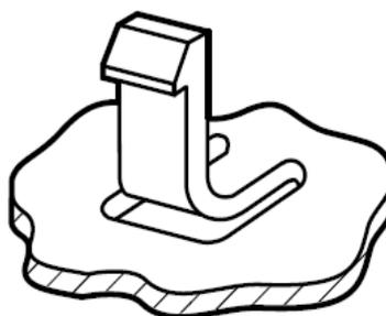
**Figura 3. 8 - Snap-fit em “L”** <sup>[10]</sup>
