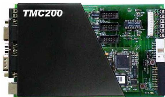
Figura 3.2:3 - Placa dos motores TMC200 [28]
