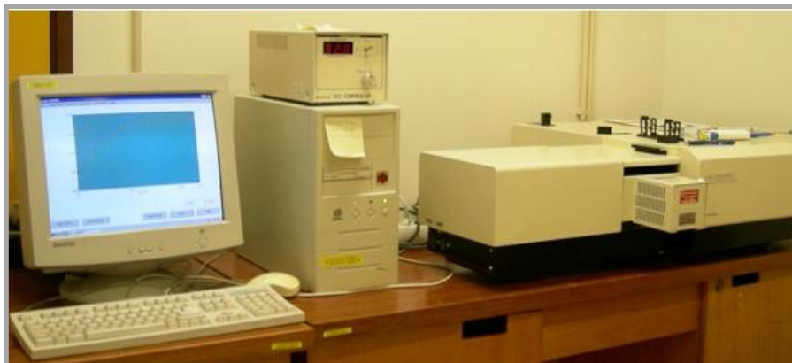
Figura 5.31 - Montagem experimental para medição de absorvências. Constituída por espectrofotómetro, forno para controlo da temperatura das cuvets e computador para aquisição de dados.
