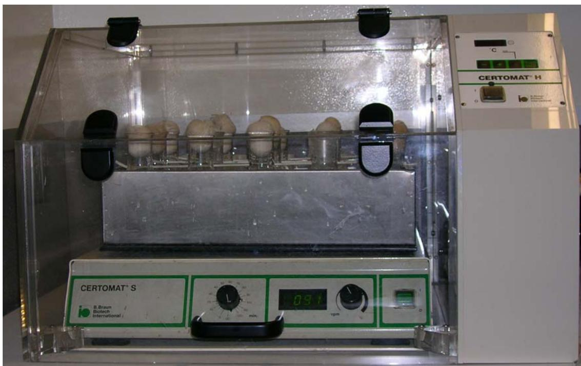
Figura 3.4.2.1- Bateria de erlenmeyers para determinação de equilíbrios de biossorção.
