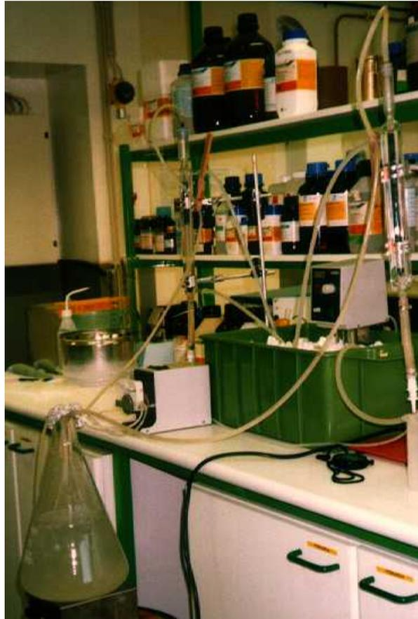
Figura 3.4.3.1.1.1- Instalação laboratorial para a realização de ensaios de bioissorção, sistema aberto.
