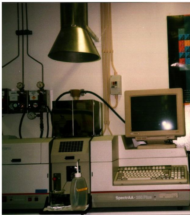
Figura 3.5.1.1- Espectrofotómetro de Absorção Atómica, VARIAN SPECTRA AA 400-GTA 96 PLUS.
