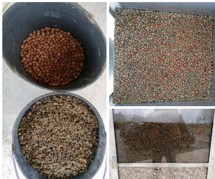
Ilustração 15 - Aplicação da argila expandida com e sem incorporação de pontas de cigarro no meio poroso não convencional
