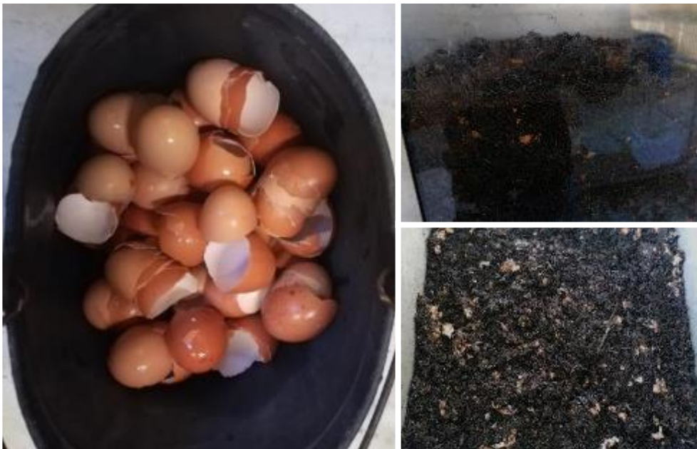
Ilustração 16 – Incorporação de cascas de ovos numa mistura com substrato vegetal e sua aplicação no meio poroso não convencional
