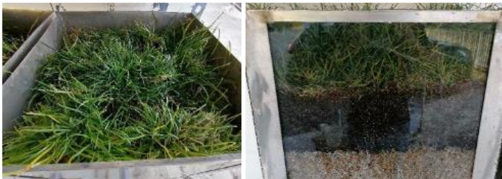
Ilustração 13 - Relva da espécie ophiopogon japonicus colocada no topo dos meios porosos de ambas as instalações-piloto
