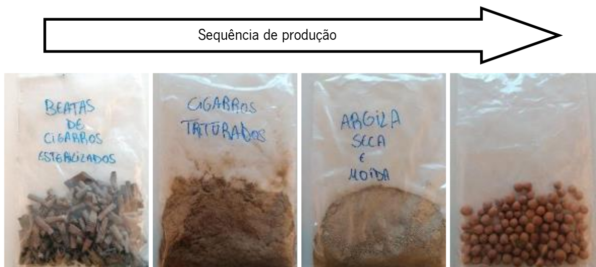
Figura 14 – Sequência de produção da argila expandida incorporada com pontas de cigarro: as pontas de cigarro são esterilizadas e em seguida trituradas; depois são misturadas com argila seca e moída, seguindo-se a formação das esferas; e por fim, sofrem um processo de cozedura, transformando-se no produto final
