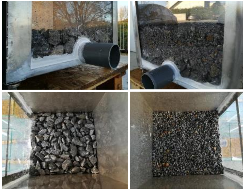
Ilustração 12 - Constituição da base drenante dos meios porosos dos CB
