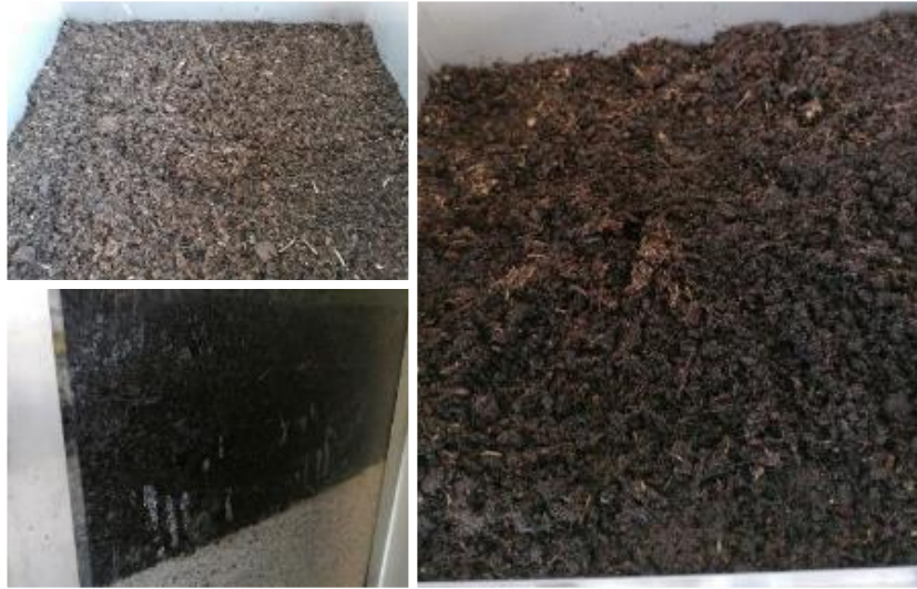
Ilustração 19 – Camada de substrato vegetal no canteiro de biofiltração convencional
