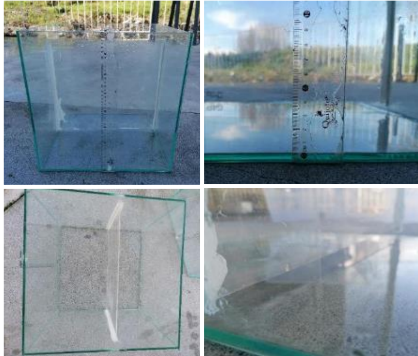
Ilustração 6 - Caixas de vidro utilizadas na recolha e medição do volume e caudal do efluente
