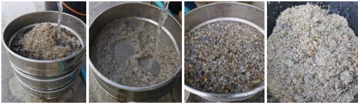
Ilustração 11 - Processo de lavagem da areia selecionada através de peneiros normalizados
