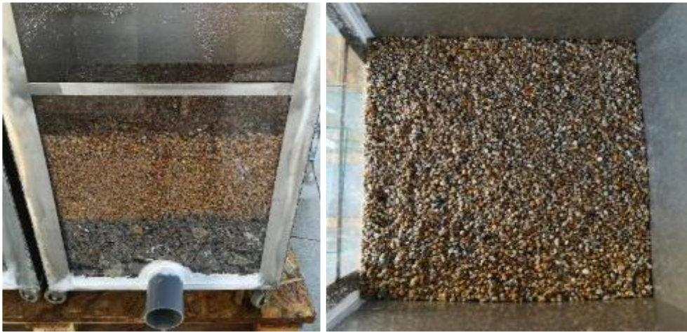
Ilustração 17 – Camada de 0,3 m areão utilizada no canteiro de biofiltração
