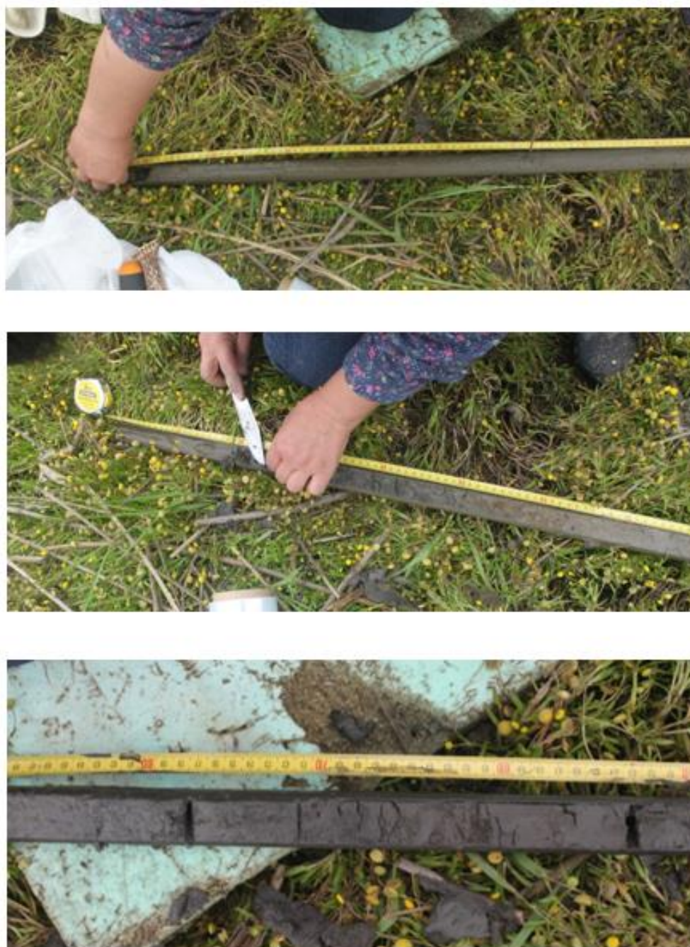
Figura 43 - Medição e separação do material recolhido com trado
