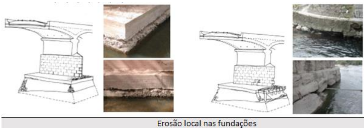
Figura 11 Erosão local nas fundações (García-Catalán & Álamo, 2006)
