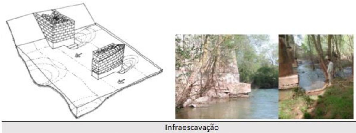
Figura 12 Infraescavação nas fundações (García-Catalán & Álamo, 2006)
