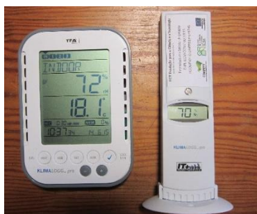
Figura 65 - Data logger TFA à esquerda; Transmissor independente TFA à direita
