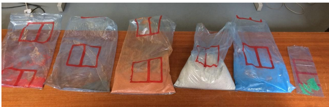
Figura 3.7 – Individualização da granulometria das areias por areia retida em cada peneiro
