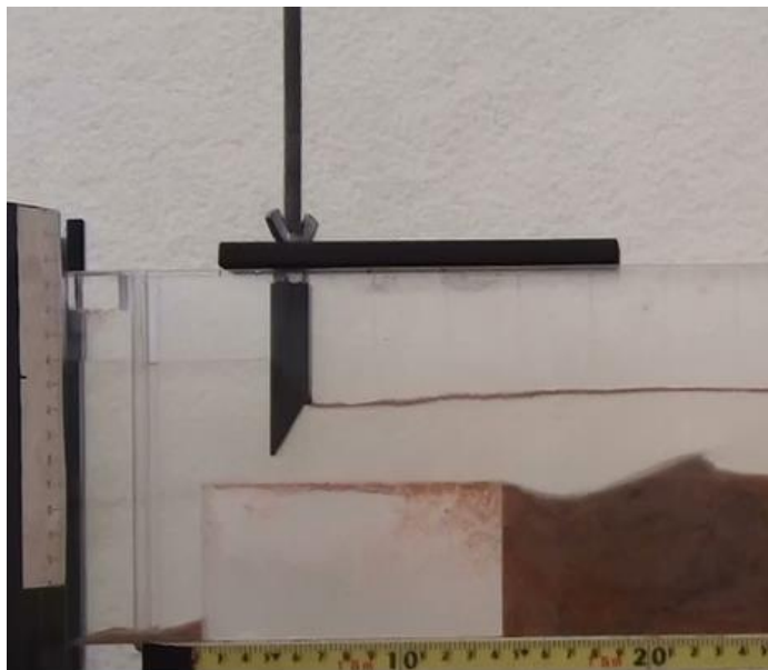
Figura 3.2 – Comporta vertical de soleira delgada com abertura inferior
