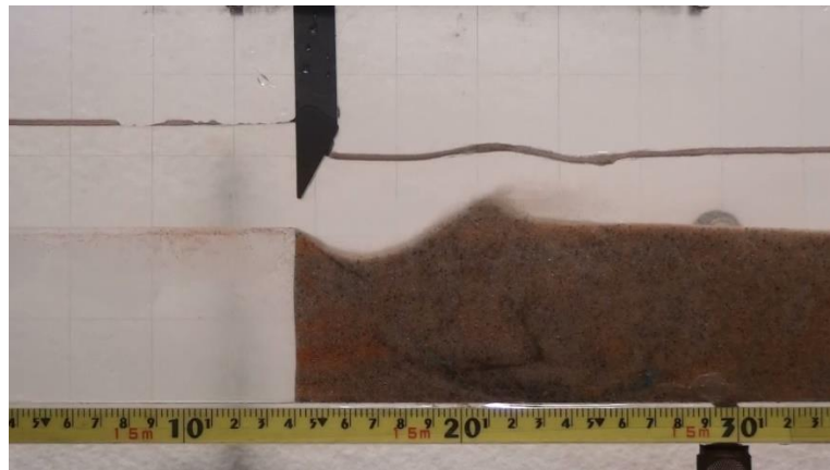
Figura 4.6 - Imagem do leito de sedimentos, obtida para Q=0,0861 L/s, b=0,9 cm, P=1 cm e L=0 cm (Ensaio n.º 1), para t=5 s (pormenor)
