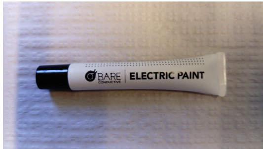
Figura 43 - Tinta condutora utilizada na preparação dos ensaios.
