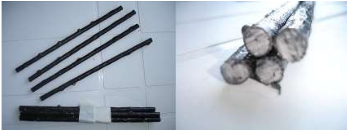
Figura 42 - Aspeto dos varões após o corte.
