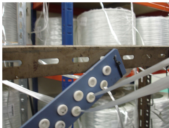
Figura 32 - Olhais cerâmicos por onde são encaminhadas as fibras para produção dos varões
