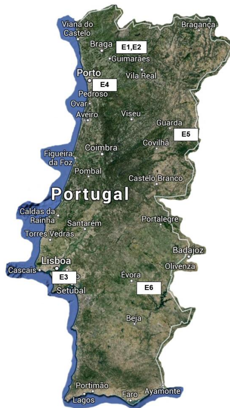
Fig. 2.3 - Localização dos ambientes reais. E1 – Referência (Guimarães); E2 – Humidade (Guimarães); E3 – Carbonatação (Lisboa); E4 – Cloretos (Porto); E5 – Gelo/degelo (Guarda); E6 – Temperaturas elevadas (Elvas).
