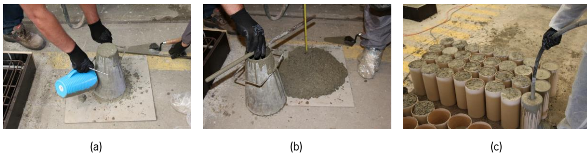
Fig. 3.5 – Caracterização do betão utilizado: (a) e (b) ensaio de slump ; (c) vibração do betão dos cilindros.
