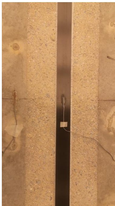
Fig. 3.18 – Processo de reforço da faixa de laje EBR-MA: (a) máscaras; (b) calha para controlo da flecha durante o pré-esforço; (c) apoios da faixa de laje; (d) instrumentação do laminado de CFRP e do betão da faixa de laje; (e) adesivo a curar; (f) adesivo curado.
