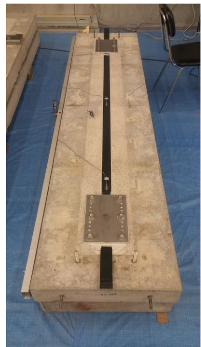
Fig. 3.18 – Processo de reforço da faixa de laje EBR-MA: (a) máscaras; (b) calha para controlo da flecha durante o pré-esforço; (c) apoios da faixa de laje; (d) instrumentação do laminado de CFRP e do betão da faixa de laje; (e) adesivo a curar; (f) adesivo curado.
