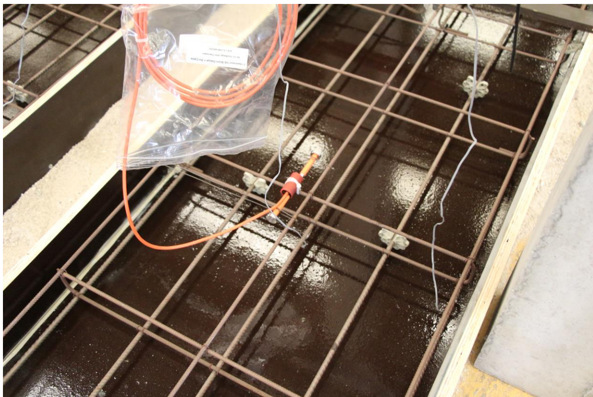
Fig. 3.3 – Instrumentação nas faixas de laje.
