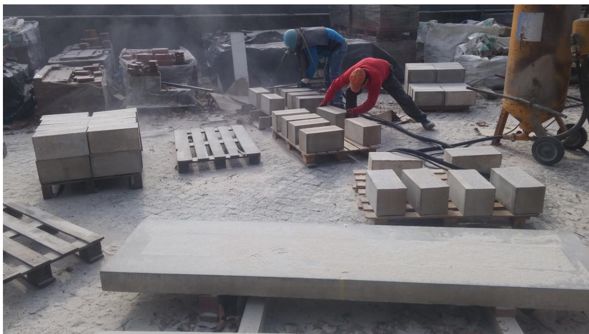
Fig. 3.6 – Tratamento de superfície (jato de areia).
