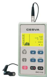
Figura 9: Exemplo de instrumento de medição – dosímetro (Ambergo, 2019)
