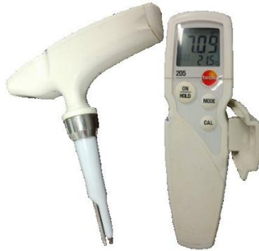
**Figura 5. Medidor de pH Testo 205**
