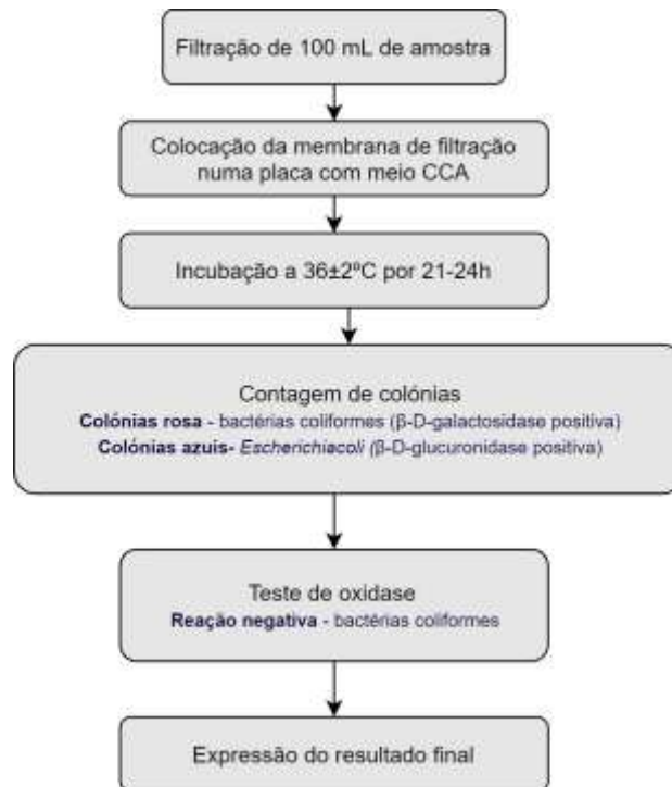
Figura 7. Fluxograma do procedimento para a contagem de Escherichia coli e coliformes em águas.
