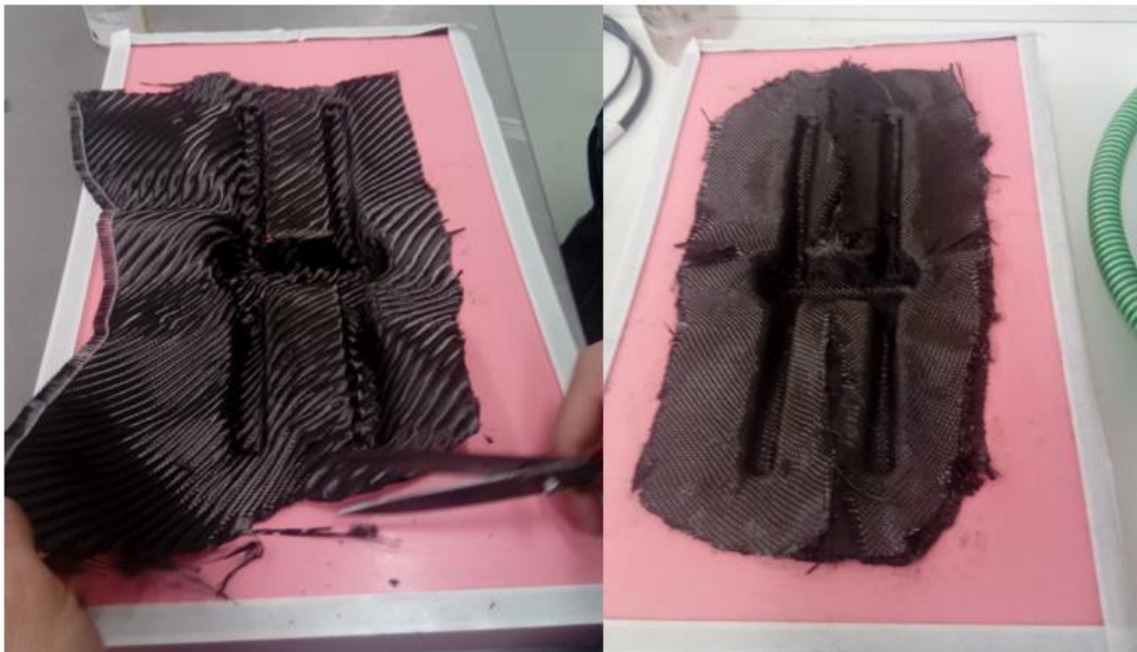
Figura 52 - Posicionamento dos tecidos de fibras no molde. À esquerda, após deposição da primeira camada de tecido e, à direita, após colocação de todas as camadas.
