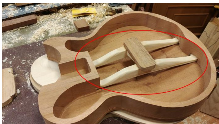
Figura 25 - Reforço interno da guitarra Maruxa (área marcada a vermelho) que se pretende substituir.
