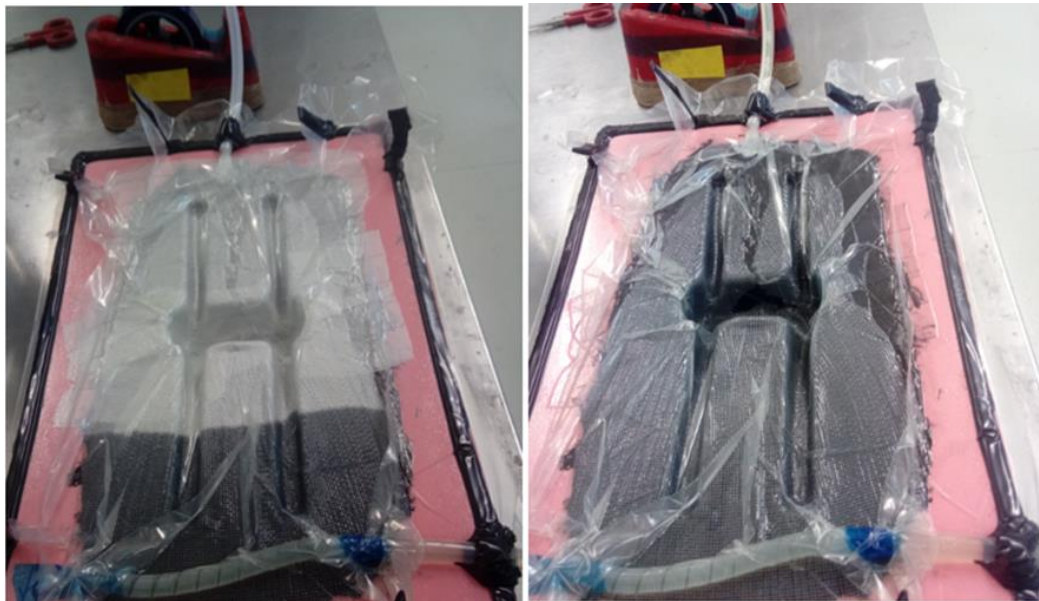
Figura 56 - Fotografias ilustrativas do processo de infusão.
