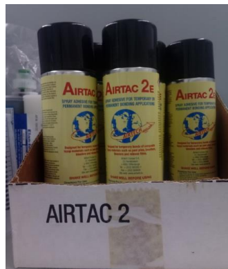
Figura 51 - Cola em spray Airtac 2E utilizada para posicionar as camadas de tecido no molde.
