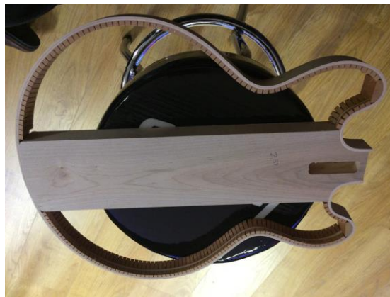
Figura 6 - Laterais e bloco interior de uma Guitarra Gibson ES-335 modelo de 1959 [14]
