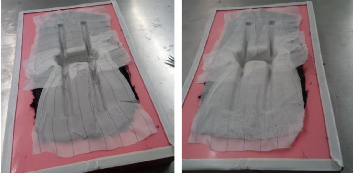
Figura 53 – Aspeto do molde após deposição do peelply , à esquerda, e do flow mesh , à direita.
