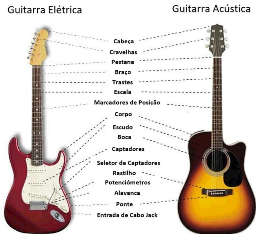
Figura 3 - Comparação esquemática de componentes de uma guitarra acústica e de uma guitarra elétrica. [10]
