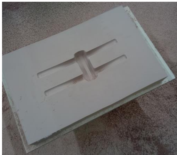
Figura 46 - Fotografia do molde final após o processo de maquinação.
