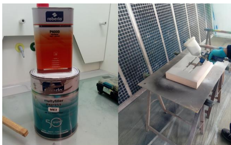
Figura 48 – Recipientes com os constituintes do primário à esquerda e, à direita, ilustração da aplicação do primário na estufa de pintura do PIEP.
