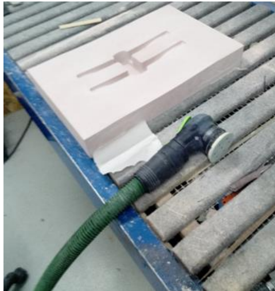
Figura 47 - Fotografia da lixadora pneumática utilizado no processo de lixagem ao lado do molde.
