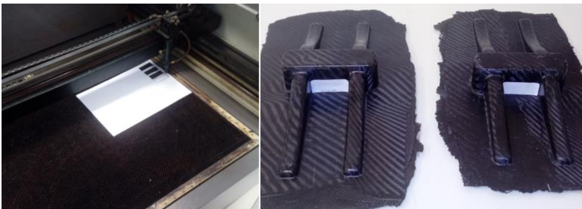
Figura 58 - Corte laser das marcações em papel à esquerda e, à direita, colagem das marcações nas peças.
