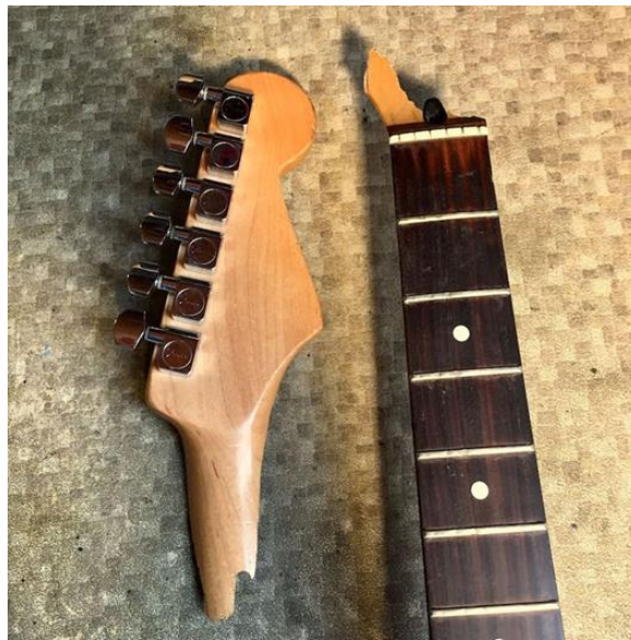
Figura 19 - Quebra do braço duma guitarra Fender Stratocaster na zona de transição da escala / cabeça [33].
