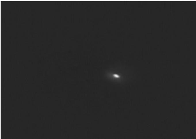
**Figura 4.1** Imagem de fluorescência da amostra de h-BN com recurso a câmara Andor *Luca EMCCD* equipada com um filtro de interferência para transmissão apenas do comprimento de onda de fluorescência, mostrando uma região de interesse para análise FLIM.
